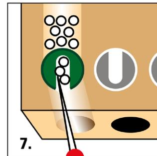
7. In seltenen Fällen kann es vorkommen, dass der Dosierkopf mit Globuli verstopft ist. Mit einer Stecknadel vorsichtig die Globuli aus dem Dosierkopf herausnehmen und den Dosiervorgang wiederholen.
