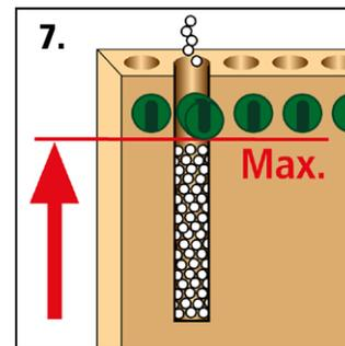
7. Aber nur bis zur Öffnung des Dosierkopfs, d.h. ca. 5 mm unterhalb des Randes, so dass der Dosierkopf problemlos wieder eingedrückt werden kann.
