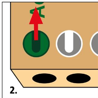
2. Drehen sie den grünen Dosierkopf mit dem beiliegenden Dreher in die Position (siehe Abbildung), dass die offene Stelle des Schlitzes nach oben zeigt.
