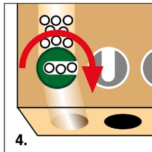
4. Drehen sie den Dosierkopf eine halbe Umdrehung (180°), bis die Schlitzöffnung nach unten zeigt.
