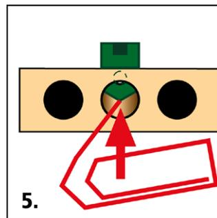
5. Stecken sie dann das Ende der Büroklammer unter den Dosierkopf und heben sie diesen vorsichtig nur soweit heraus, wie in der Abbildung gezeigt.
